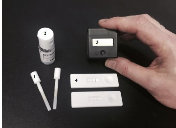
Figura 1. Kit Cortisol Analysis. 1: Colector oral; 2: Solución Buffer; 3:LFD- Cortisol; 4:Cube Reader ™ . Imágenes cedidas por SOMA Bioscience, UK ®
