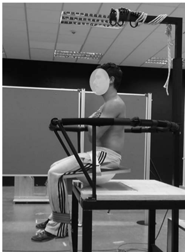
Figura 2. Vista lateral de un participante durante la ejecución de una prueba sobre asiento inestable. El asiento está apoyado sobre una plataforma de fuerzas que permite el análisis del desplazamiento del centro de presiones y de esta forma, la valoración del control postural del tronco en sedestación. Una barandilla de seguridad rodea al participante para evitar caídas y hacer que este se sienta seguro durante la prueba.
